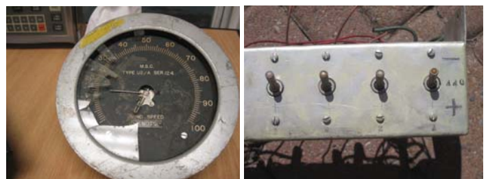
L'écriture sur ce cadran d'aéronef brisé (gauche) et le bout des interrupteurs à levier (droite) brillaient dans le noir à l'aide d'une peinture lumineuse au radium.
